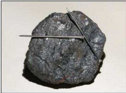
Bild I: Magnetstein / Magnetitkristall
