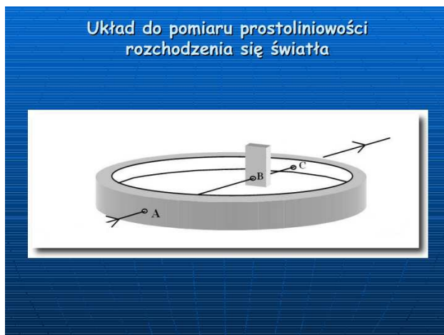
Rys.5. Slajd prezentacji ukazujący schemat układu do pomiaru prostoliniowości rozchodzenia się światła
